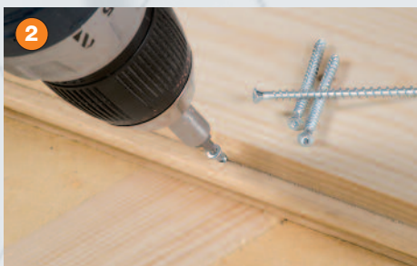
2 Dankzij de kleinere schroefdraadspoed worden de onderdelen nu al samengetrokken
