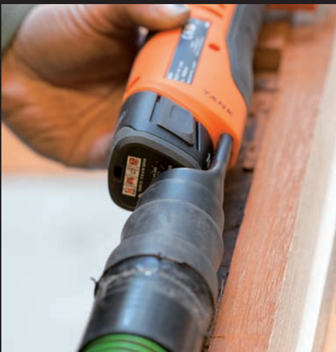
Slim: klik de geïntegreerde stofafzuiging naar achteren en je kunt de accu wisselen.
